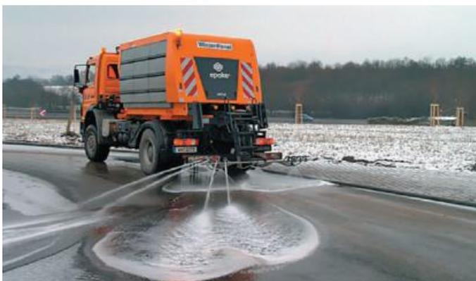
— На дорогах страны используются два типа противогололедных реагентов: химические (галиты марки А и Б, он же натрий хлористый), а также химико-фрикционные (песчано-соляные смеси) — составы песка с солью в пропорциях 1:5, 1:4, 1:1, — комментирует заместитель начальника государственного производственного объединения «Горремавтодор» Анатолий Жамоздин. — Технической солью посыпают основные автомагистрали страны, смесью с песком — второстепенные улицы.
